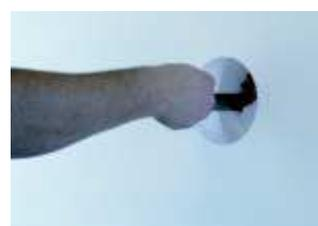
Appliquer le mortier adhésif sur la surface circulaire du cylindre de montage MARCOTHERM ROUND-PU. L'élément doit être complètement collé sur toute la surface de la base.
